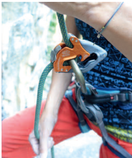
Abb. 8 Click Up + in arretierter Position mit neuer Geräteform, Trennelement und sichtbaren seitlichen Federn, die den Karabiner in der nicht arretierten Position halten und so für ein geschmeidigeres Seilausgeben sorgen.
